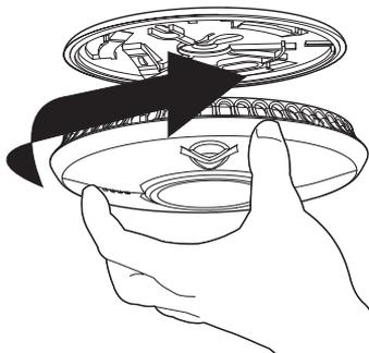
Sobald der Rauchmelder richtig an der Montageplatte befestigt wurde, wird die im Gerät fest integrierte Long-Life-Batterie aktiviert. Die rote LED an der Vorderseite des Rauchmelders sollte nun ein Mal alle 40 Sekunden blinken, um anzuzeigen, dass er aktiviert ist.
